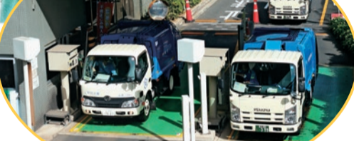
▲ごみ収集車は、プラットホームに入る前に、ごみ計量機でごみの重さを量ります。1台のごみ収集車に約1.5~2トンのごみが入っています
