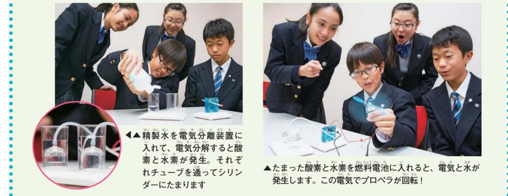
▲精製水を電気分離装置に入れて、電気分解すると酸素と水素が発生。それぞれチューブを通してシリンダーにたまりませ
