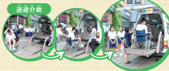
デイサービスの利用者を施設の車で送迎します。車の後部には電動のリフトが付いていて、体の不自由な人が車いすのまま車内に移動できるようになっています。昇降中の事故などが起こらないよう、車いすをベルトやフックでしっかりと固定し、動かす時には必ず声をかけます
