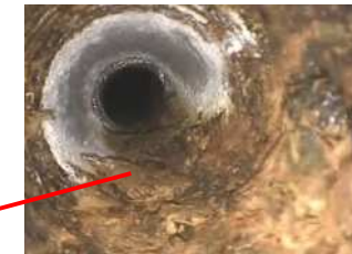
<配管内部の劣化>
