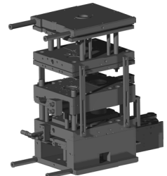
高機能ターボファンの金型 (用途:自動車の背中と座面シートのエア送風ファン成形)
