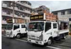
電力工事に欠かせない電源車
