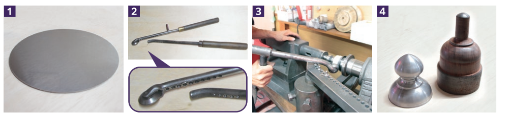
ヘラ絞りの機械は横向きの軸が回転するようになっていて、木型や金型をはめ、型に沿わせるようにヘラを使って成形していきます。
