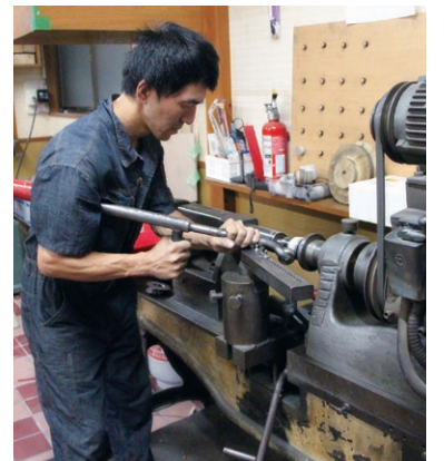
ヘラ絞りの機械は横向きの軸が回転するようになっていて、木型や金型をはめ、型に沿わせるようにヘラを使って成形していきます。
