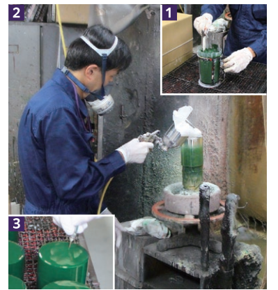
1 塗料は色や環境で希釈の度合いが異なるのでその場で調合。2 ろくろに載せた缶に吹き付け塗装。3 針で支えて入れ替えます。
