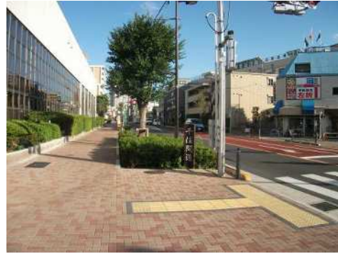
壁面を後退して道路植栽と一体的に接道部の緑化を図り、圧迫感を軽減した例 (荒川総合スポーツセンター)
