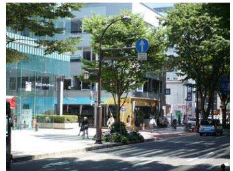
照明柱と道路標識の集約化・デザインの統一がなされた占用物(仙台市)
