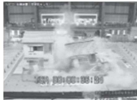
写真：耐震補強の有無による震災被害の検証
