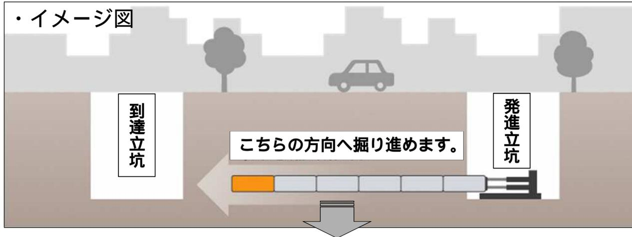
・詳細イメージ図(小口径管推進工法)
