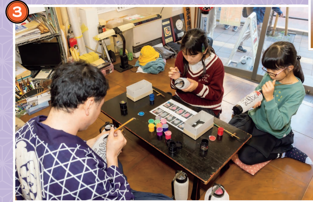
「明かりを点した時、色ムラが透けて見えないようにするため、筆先で塗料の厚みを調整するのがポイント」と村田さん
