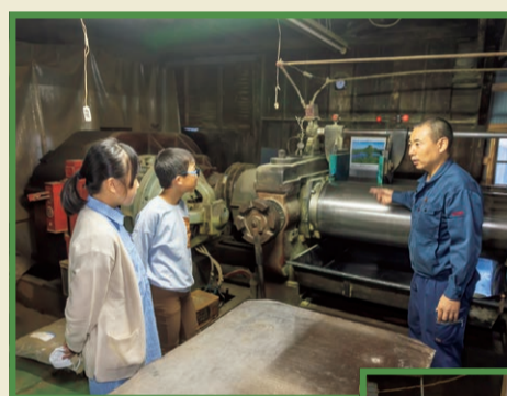
◀ロール機は大人が両手を広げたくらい大きさ。一度に多くの材料を練ることができます
