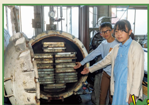
▲ジュニア記者たちの背丈ほどもある大きな釜。途中で釜を開けることはできないため、上部の圧力計は、中の様子を正確に確認する大切な機器です
