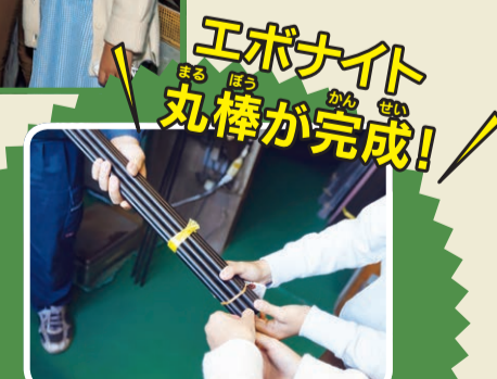
できあがったエポナイト丸棒は、電気絶縁材や万年筆の素材、楽器・音響パーツなどに利用されます
