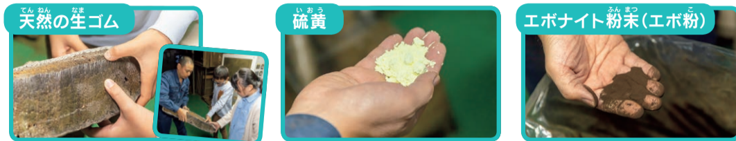
▲天然の生ゴム ▲ゴムの木から採れる樹液を固めた生ゴムの塊。輪ゴムやゴムテープの、のりの原材料でもあります ▲硫黄 ▲温泉の成分として知られる硫黄。サラサラとした細かい粉状で、薄い黄色が特徴です ▲エポナイト粉末(エポ粉) ▲エポナイトを粉状にしたもの。生ゴムと硫黄を混ぜる際、二つの素材の結びつきを強化する“つなぎ”の役割をします
