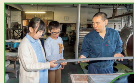
▲加硫前は少し柔らかさが残っていますが、加硫後は硬度が増してプラスチックのような質感になります
