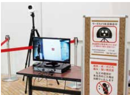
入館時に検温を行う非接触型検温器(サーモグラフィー)
