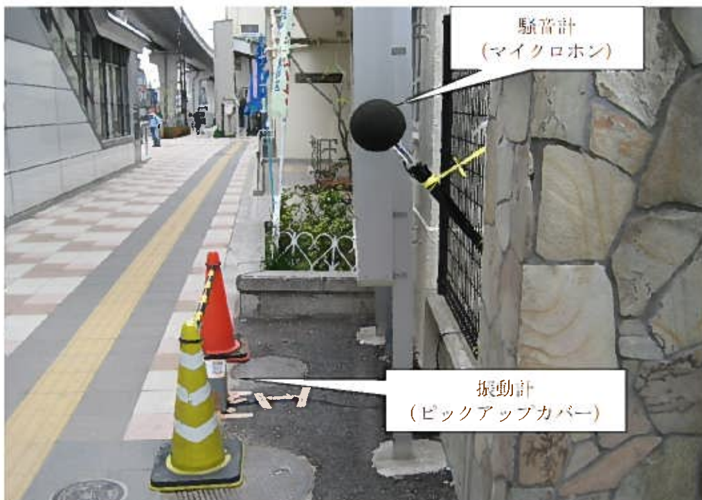
▲道路交通騒音・振動調査機器
