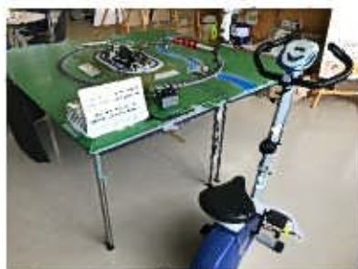
▲エアロバイク型発電機
