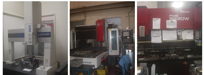
三次元測定機 XYZAX SVF NEX 6/5/3-X1 X 600 Y 500 Z 300 迄測定可能
