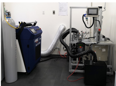
令和5年に導入したファイバーレーザー溶接機とロボットのライン
