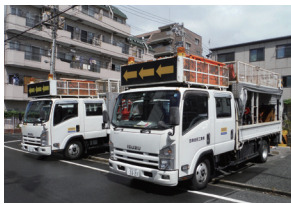
電力工事に欠かせない電源車
