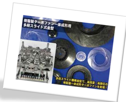
P15：樹脂製ターボファン一体成形用 多段スライド式金型(平成28年度) 松田金型工業株式会社
